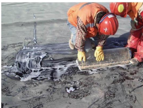
Verificación de una soldadura de extrusión por medio de la prueba de caja de vacío.
