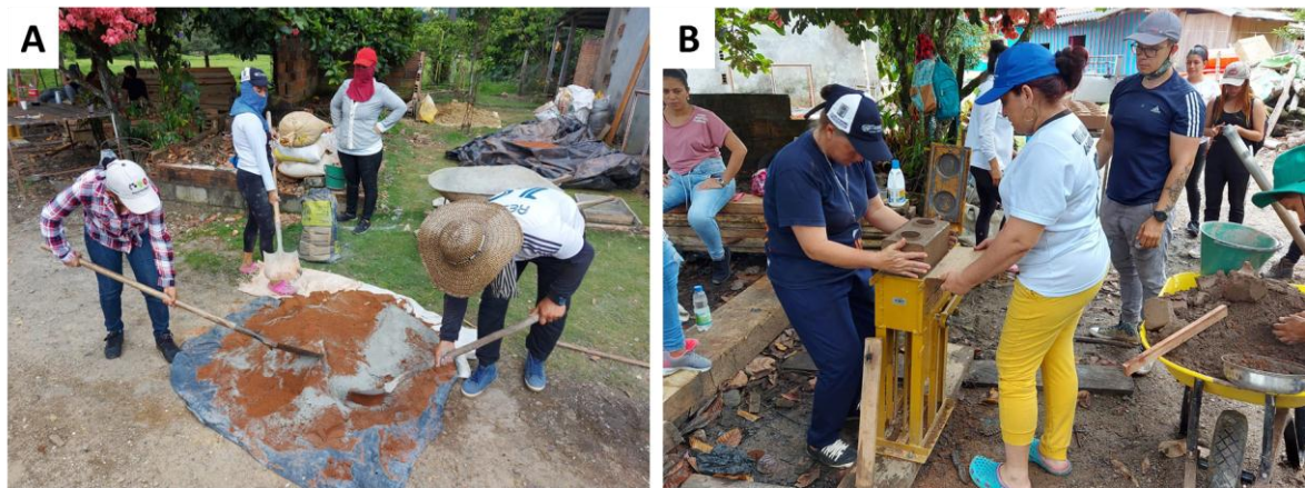
Figura 5: A) Fabricación de mezcla para BTC. B) Producción de BTC por parte de estudiantes de la Tecnología en Gestión Ambiental.
