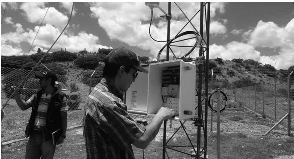
Instalación de una estación agrometeorológica profesional telemétrica en el municipio de San Lucas.
