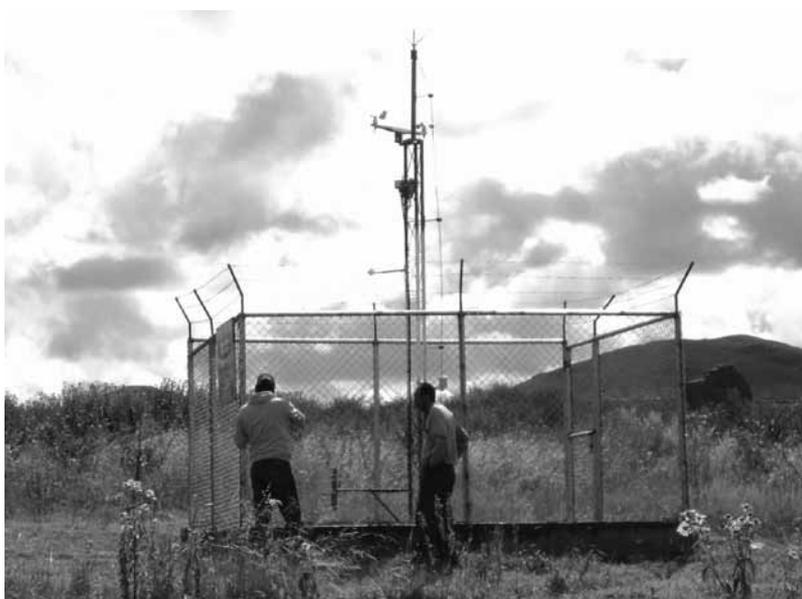
El sistema comprende cuatro estaciones agrometeorológicas telemétricas con transmisión de datos en tiempo real.
